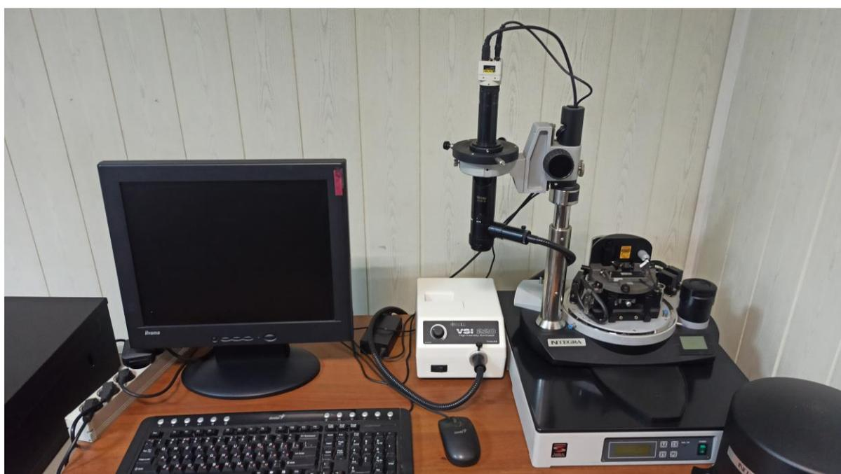
**NTEGRA AURA** является высокоэффективным исследовательским комплексом методами СЗМ в вакууме, позволяя выходить на рабочий режим значительно быстрее нежели аналогичные высоковакуумные системы, при этом вакуум, обеспечивающий десятикратное увеличение добротности, достигается всего за 1 минуту! Компактность и легкость в обслуживании являются так же серьезными преимуществами прибора.
